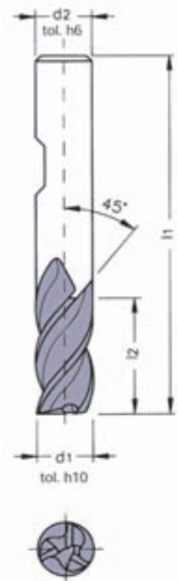
**Impiego:** Fresatura generale e scanalature. Adatte per tutti i tipi di metalli tenaci.
