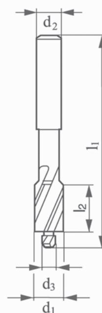
Taglienti elicoidali destri a 27° -Tolleranze:diametro d1 z9, diametro d3 e8, diametro d2 h9.
