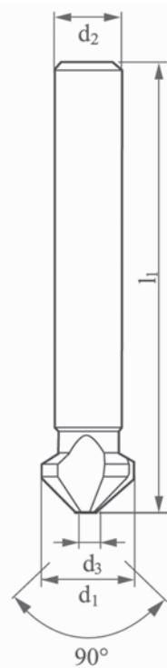
Taglio destro - Spoglia radiale anti-vibrazioni - Tolleranze: diametro d1 z9, diametro d2 h9.
