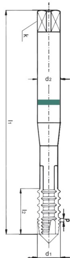
**Impiego:** Maschiatura di fori passanti. Adatti per alluminio, leghe leggere e metalli non ferrosi a truciolo lungo.
