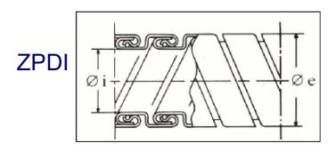
Tubo flessibile a doppia aggraffatura,in acciaio zincato a caldo con guarnizione in Kevlar per medie pressioni (es. passaggio bitumi).
